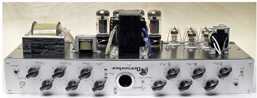
Šasi zesilovače „Black Tower“ před usazením do dřevěné skříně
