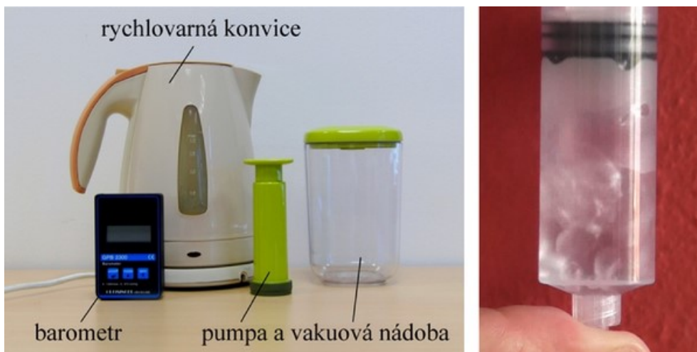
Obrázek 37: Různé varianty experimentu ukazujícího závislost teploty varu na tlaku
