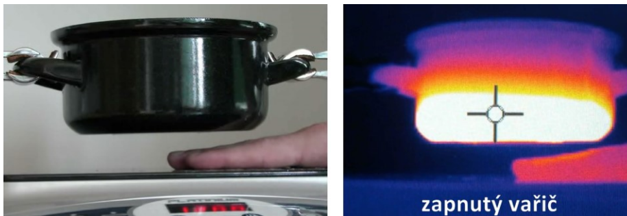
Obrázek 48: Hrnec zahříváný nad plotnou indukčního vařiče; nalevo snímek ve viditelné a napravo v infračervené oblasti, ruka je položena na plotně pod hrncem
