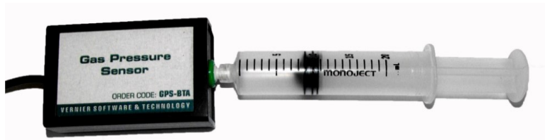
Obr. 1: Přišroubování stříkačky k čidlu tlaku
