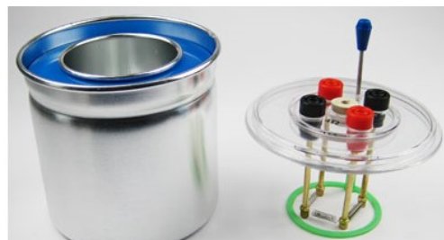
Obr. 1: Vlevo kalorimetr, vpravo topná spirála
