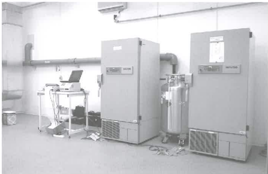
Obr. 2: Průběh validace 2 nízkoteplotných zařízení, levé slouží pro skladování nepropuštěných, pravé pro skladování propuštěných produktů.
