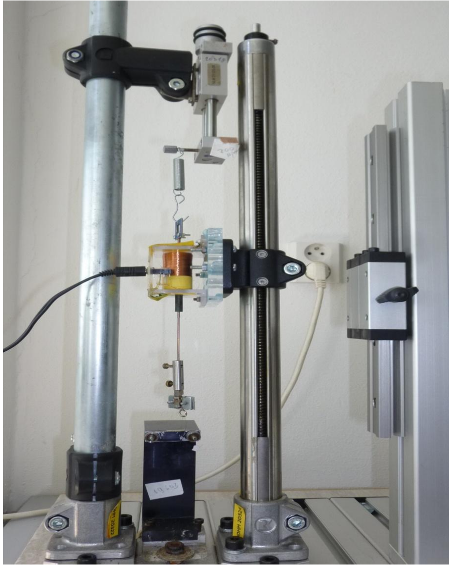
Obr. 16: Fotografie dynamického viskoelastometru s uchyceným vzorkem vlasu.
