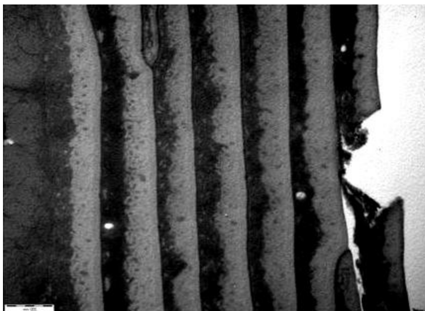
Obr. 11: Ukázka poškození kutikulární vrstvy fénováním horkým vzduchem při teplotě 95°C. Měřeno transmisním elektronovým mikroskopem [58].
