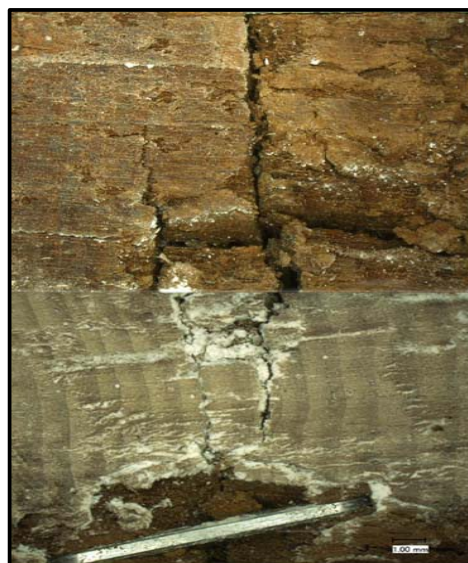
Obr. 5: Nahnílý okraj vzorku, před úpravou (nahore), po úpravě (dole).
