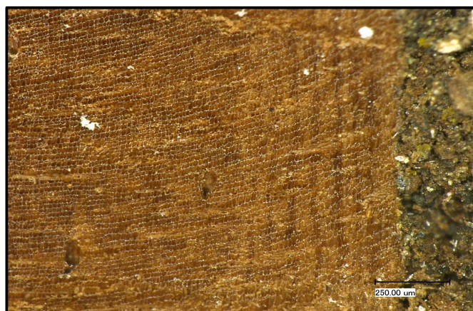
Okraj vzorku MT01204 – extrémně úzké letokruhy, nelze od sebe rozlišit jarní a letní letokruh
