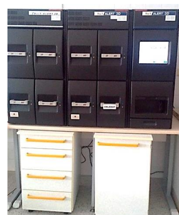
Obrázek 7 - Přístroj Bact-ALERT 3D (foto: Šárka Baláčková)
