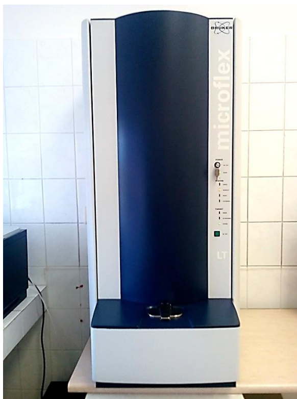
Obrázek 13 - Hmotnostní spektrometr IVD MALDI Biotyper Systém (foto: Šárka Baláčková)
