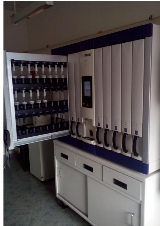
Obrázek 9 - Příklad přístroje VersaTREK/ESP kultivačního systému s otevřeným boxem (foto: Šárka Baláčková)
