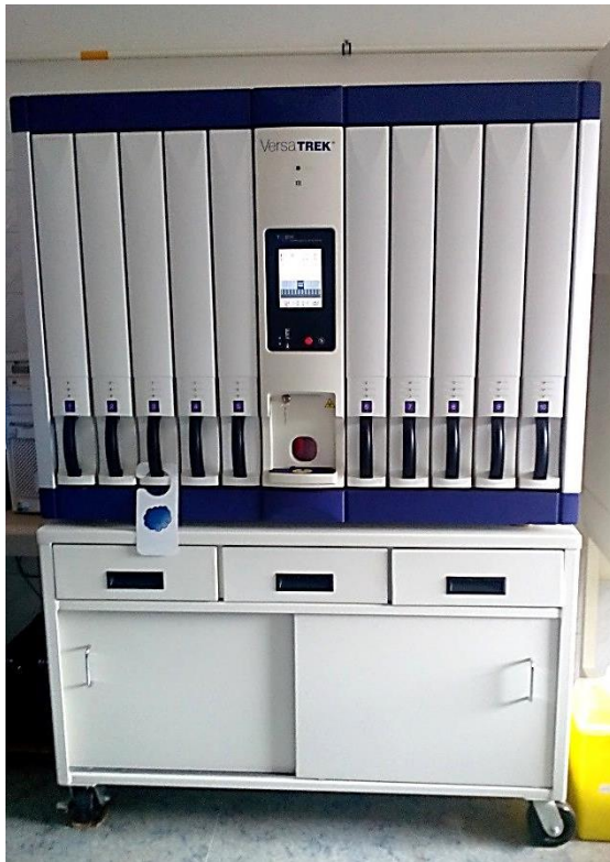
Obrázek 8 - Příklad přístroje VersaTREK/ESP kultivačního systému (foto: Šárka Baláčková)
