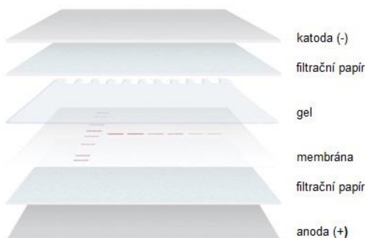
Obrázek 5: Schématické uspořádání polosuchého přenosového systému v horizontální poloze
