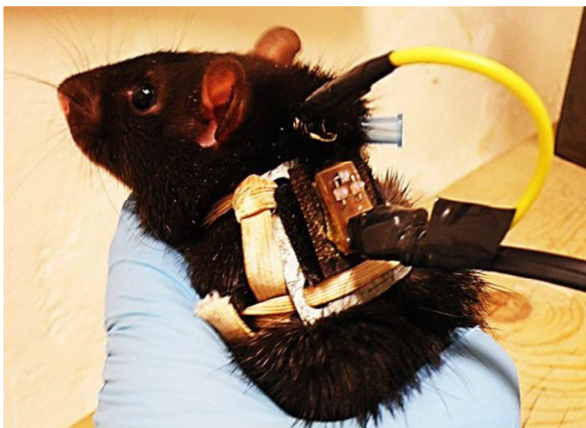
Obr. 8. Batůžeks IF diodou připevněný na zádech potkana. Krokodýlek vedoucí k subkutánně aplikované jehle slouží k udílení elektrických šoků.
