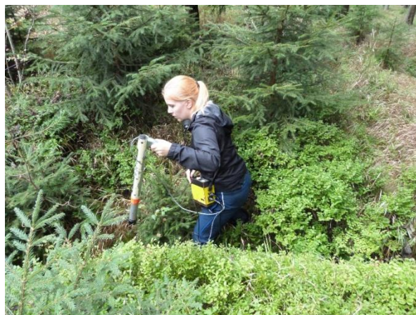
Obr. 6: Měření gama aktivity přístrojem RP 11 v terénu, Foto: Lenka Hrušková
