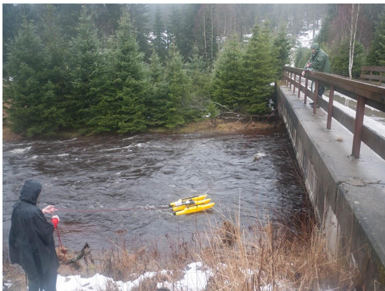
Obr. 5.17: Měření průtoku na Roklanském potoce - 1. profil (foto L. Vlček)
