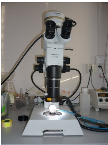
Obr. 10. Mikroskop Olympus SZX12 s kamerou Olympus DP70 (software Quick PHOTO Micro 2.3). (Vlastní archiv)
