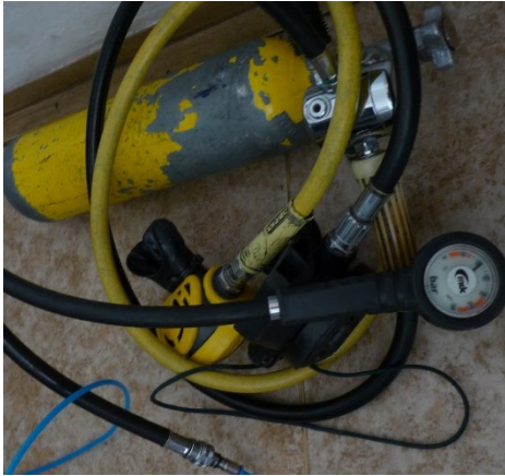
Obr. 12. Potápěčská tlaková lahev s prvním i druhým stupněm plicní automatiky, manometrem a středotlakou hadicí pro připojení a natlakování výzkumné hyperbarické komůrky. (Vlastní archiv)
