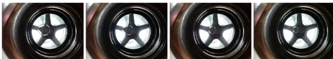
Obr. 8. Zmenšování bubliny při sycení. (Napojení na vzduchovou lahev – vlastní archiv)
