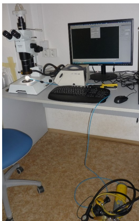
Obr. 11. Hyperbarická komůrka pod mikroskopem Mikroskop Olympus SZX12 a kamerou Nikon DS-Fi2 (software NIS-Elements AR 4.11). (Vlastní archiv)
