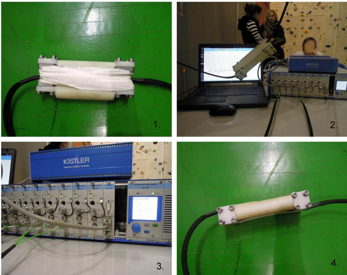
Obr. č. 4: Měřicí stanoviště a instrumentace (č. 1, č. 4 – siloměr osazený čidly Kistler, pohled z boku / pohled ze shora, č. 2 – siloměr, notebook, měřicí ústředna, č. 3 – detailní pohled na měřicí ústřednu)
