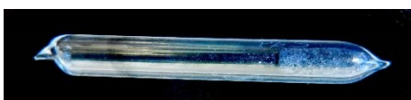
Obr. 20. Syntetický PbS v ampulce z křemenného skla po vyjmutí z pece. FOV 5 cm (foto: Čurda 2014).
