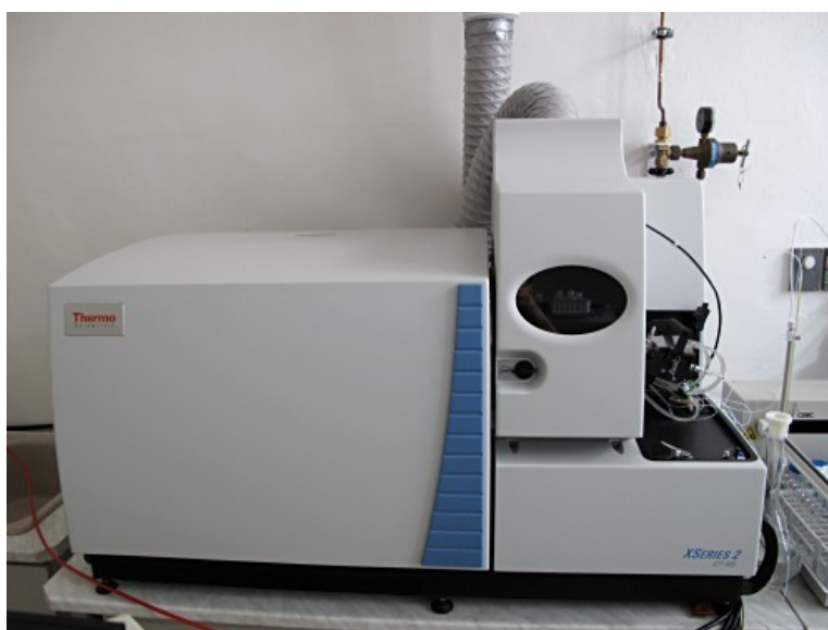
Obr. 22. Hmotnostný spektrometer s indukčne viazanou plazmou XSeries 2 Thermo Scientific; zdroj: https://web.natur.cuni.cz/lgu/labs/icpms/icpm0.html ; 18.6.2014.
