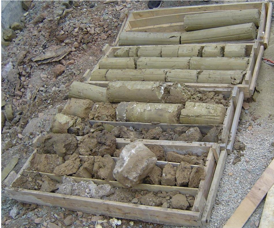
Obrázek 33: Vrtné jádro z vrtu J1 uloženo v metrových vzorkovnicích. Povrch terénu je v pravém horním rohu (fotografie Rott, 2011)
