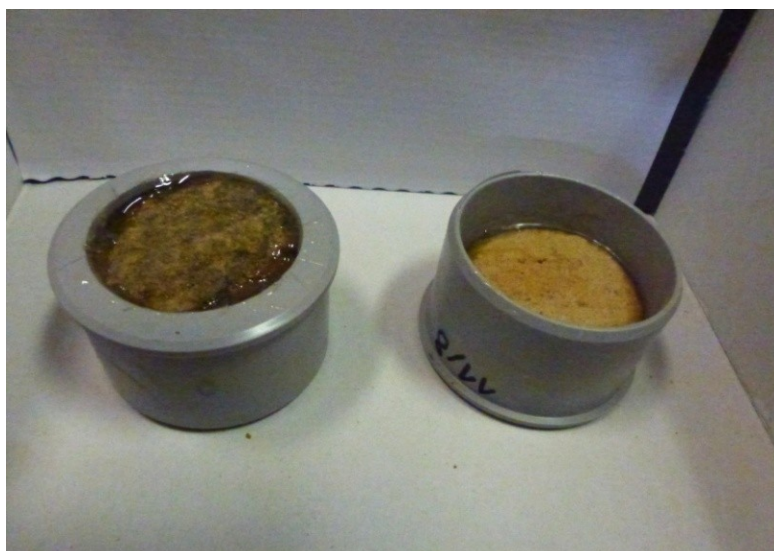
Obr. 2.8.2. Podoba části A šálku. Svrchní podstava jádra (na obrázku vlevo) je umístěna v PVC víčku tak, aby zapadla do otvoru. Vnitřní podstava jádra je znázorněna na obrázku vpravo.
