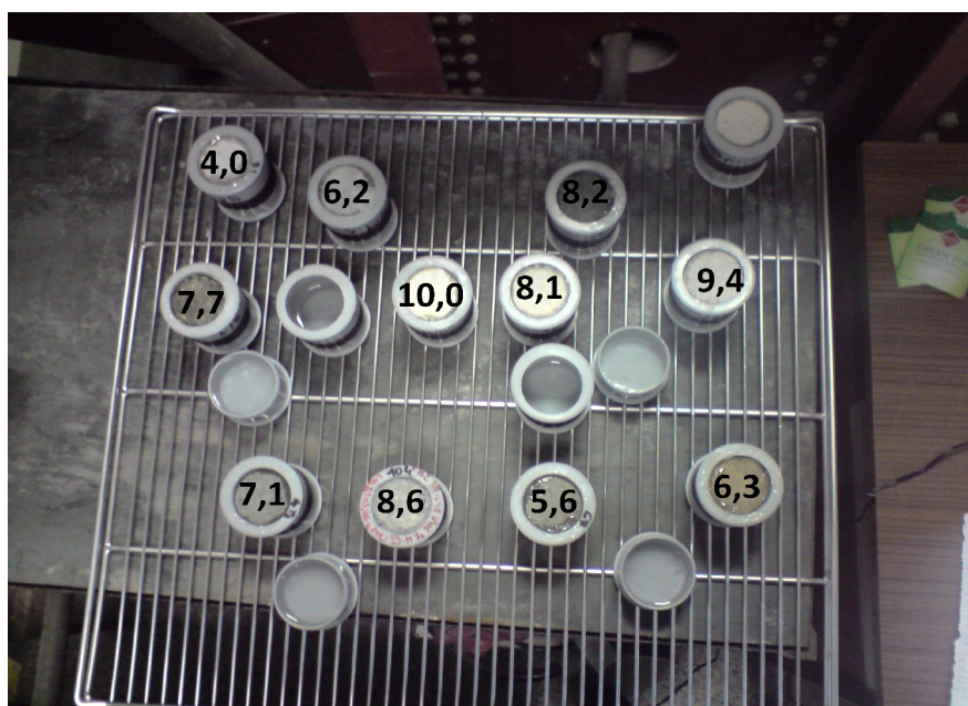
Obr. 4.2.8. Průměrné hodnoty faktoru difúzního odporu \mu jednotlivých šálků pro všechna měření (do vztahů dosazeny plochy S_{\text{svrch}} ) – hodnoty přiděleny umístění šálků v klimakomoře. Větrací zařízení je v klimakomoře umístěno v horní části obrázku.
