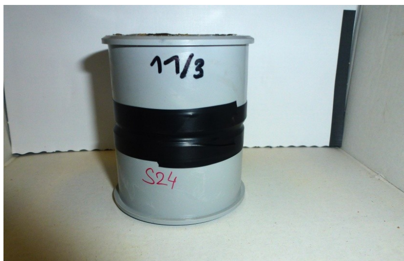
Obr. 2.8.3. Konečná podoba šálku použitého k měření paropropustnosti pískovců. V horním PVC víku (část A) se nachází pískovcové jádro, v dolním PVC víku (část B) je destilovaná voda.
