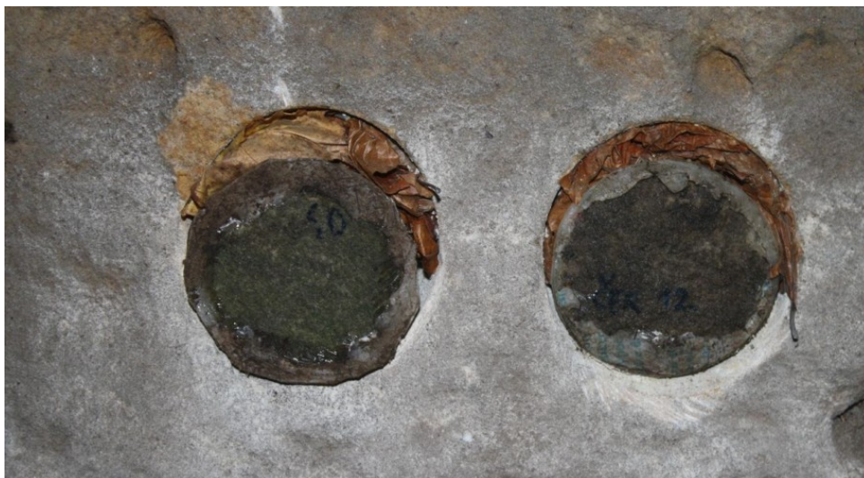
Obr. 2.4.2a. Umístění tablety do povrchu přirozeného výchozu. Vzorek a výchoz tvoří souvislou plochu.
