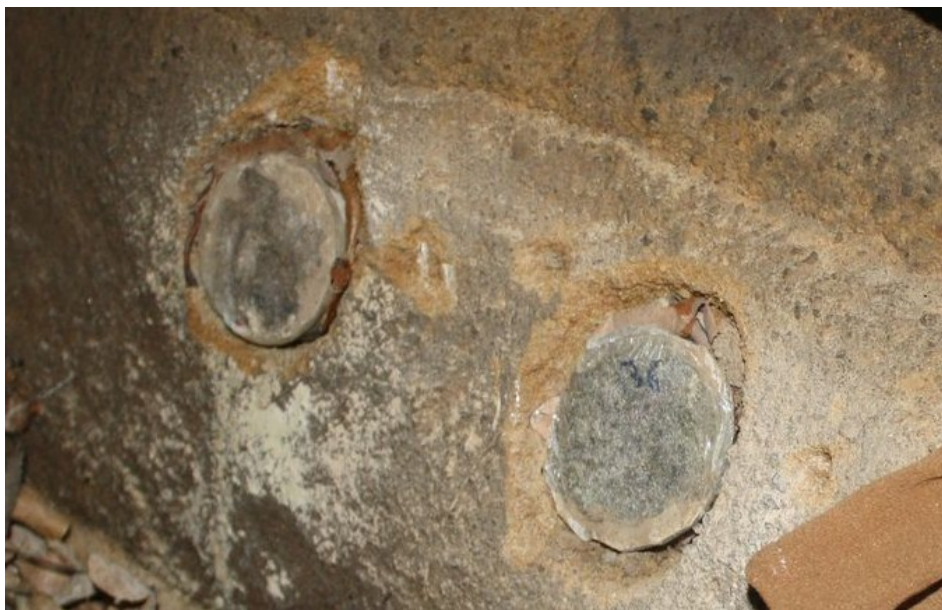
Obr. 2.4.2b. Umístění tablety do povrchu přirozeného výchozu. Vzorek a výchoz tvoří souvislou plochu.
