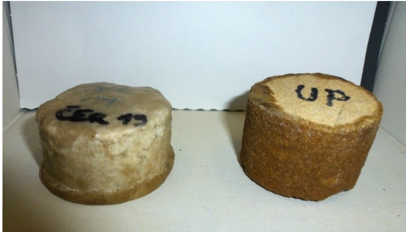
Obr. 2.4.1. Výsledná podoba jádra (tablety) zalitého do epoxidu. Svrchní podstava jádra (vpravo) zůstává nezatěsněna epoxidem, zatímco spodní podstava (vlevo) je utěsněna.
