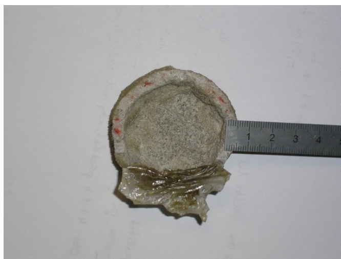
Obr. 1.1.1. Obrys epoxidového pláště okolo hrubozrného pískovce. Průnik lepidla do pískovcového jádra nemohl být vyšší než 5 mm, jinak by nedošlo k rozpadu pískovce.
