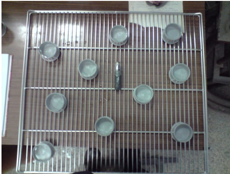
Obr. 1.4.1. Rozmístění slepých vzorků v klimakomoře. V každém patře klimakomory bylo rozmístění stejné.
