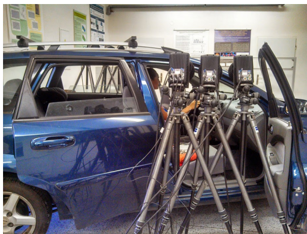
Obrázek 4.3: Rozmístění kamer pro detekci pohybu markerů
