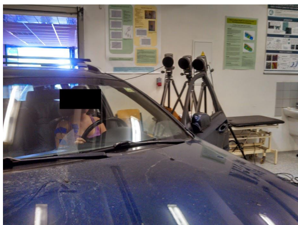
Obrázek 4.4: Rozmístění kamer pro detekci pohybu markerů
