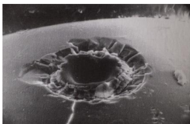
Obrázek 20 Mikro- kráter o velikosti 30\mu\text{m} . Nalezen byl na materiálu pocházejícím z Měsíce, který přivezla mise Apollo 11. Obrázek pochází ze skenovacího elektronového mikroskopu. Zdroj: Planetary Sciences
