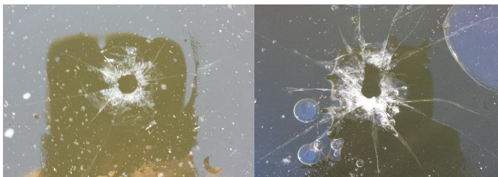
Obrázek 31 Tvar kolmého průstřelu vlevo a tvar průstřelu při úhlu 45°vpravo. Fotografie: autor práce 2013
