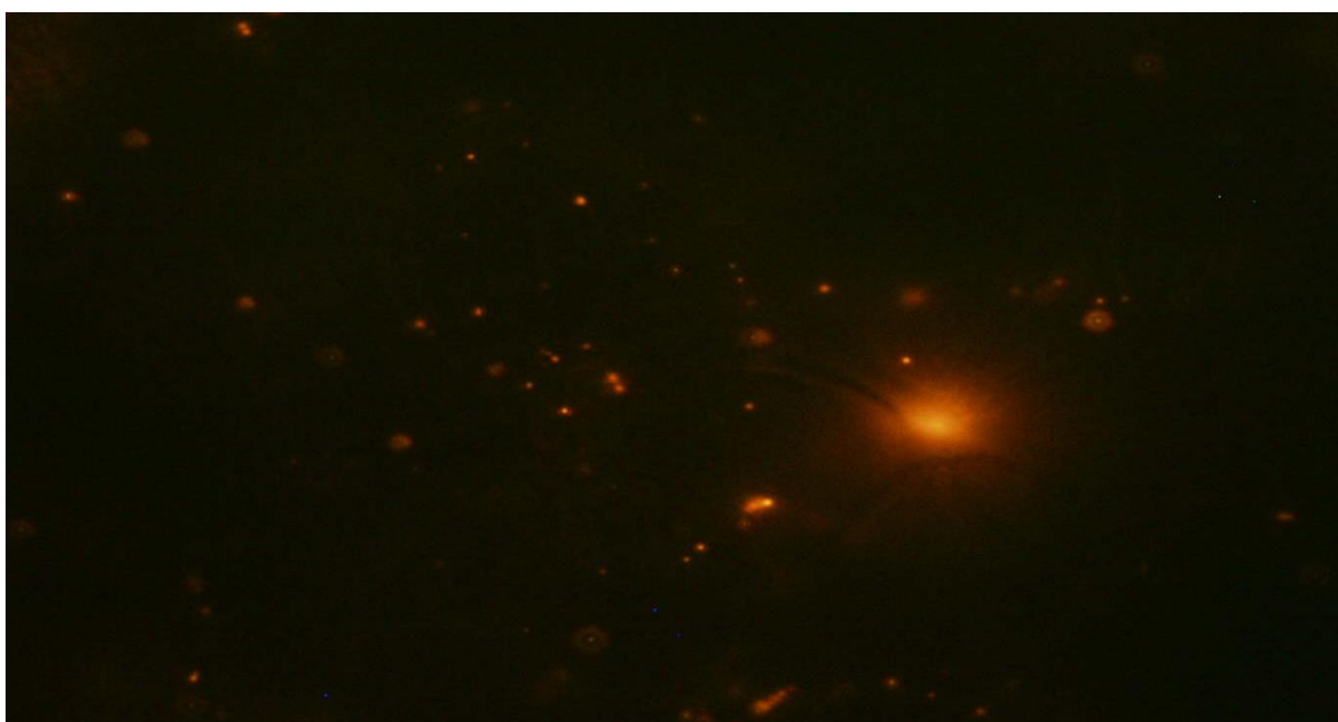
Obr. 12 - Nativní membrána fixovaná lepidlem, donorová strana, uprostřed; nastavení mikroskopu – WIB, ISO 800, zvětšení 100x, 2000 ms, zdroj VIS
