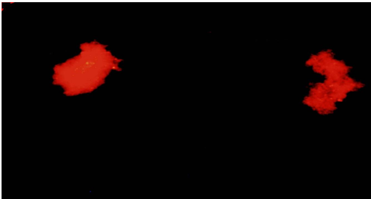
Obr. 5 - Karboxylované nanočástice založené na PD polymeru (značené Chromeonem 470) dispergované ve fosfátovém pufru dle Sørensenova o pH 6,6; nastavení mikroskopu: filtr WIB, ISO 400, zvětšení 100x, 2000 ms
