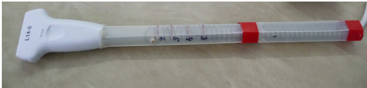
Obr. 22 Experimentální konstrukce siloměru
