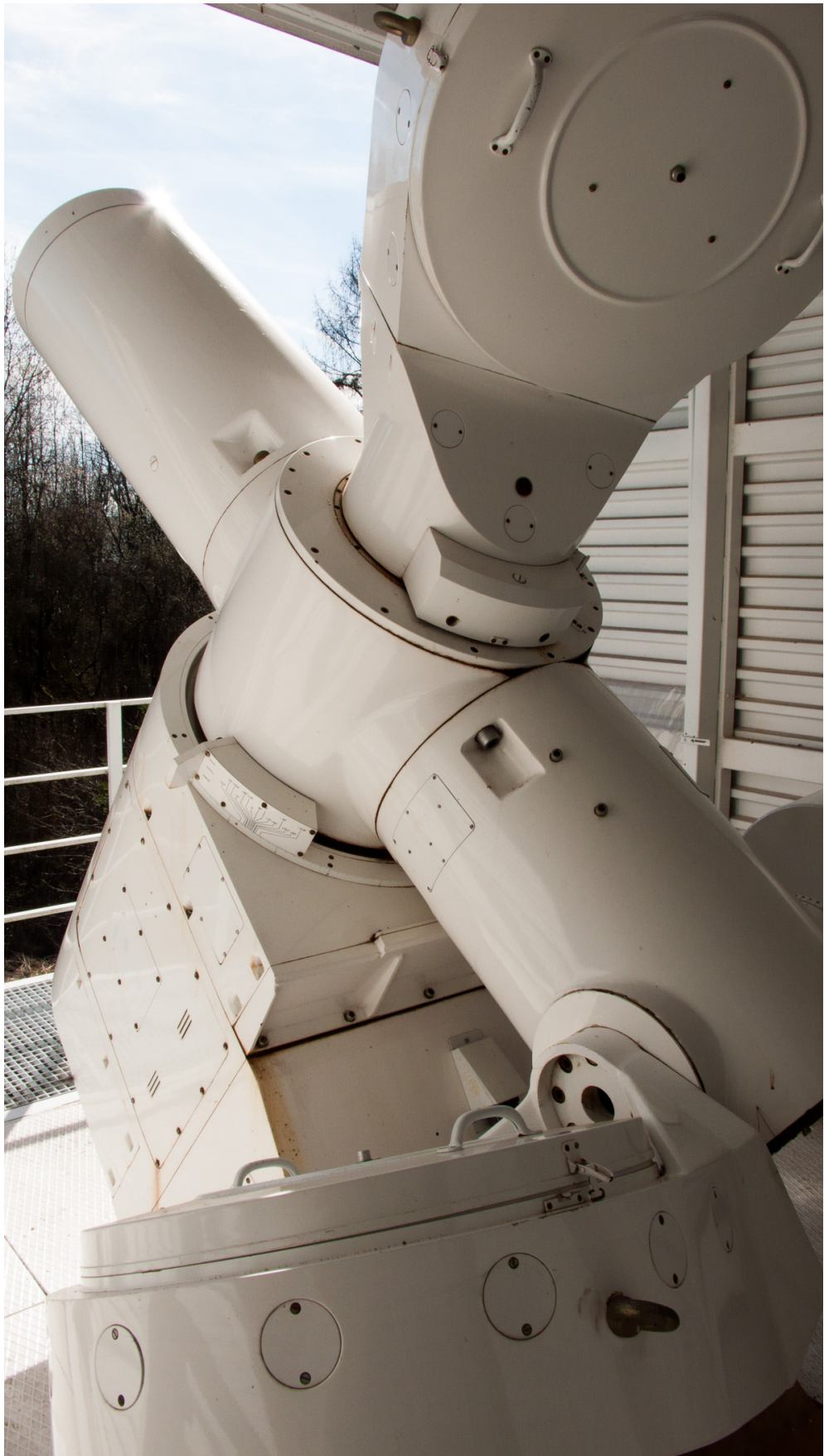
Obrázek 3.6: Celostat na dalekohledu HSFA2 se zakrytovanými zrcadly. Dole je první zrcadlo, které se během dne otáčí s celou konstrukcí kolem polární osy vedoucí přibližně z levého spodního rohu obr. do pravého horního rohu.
