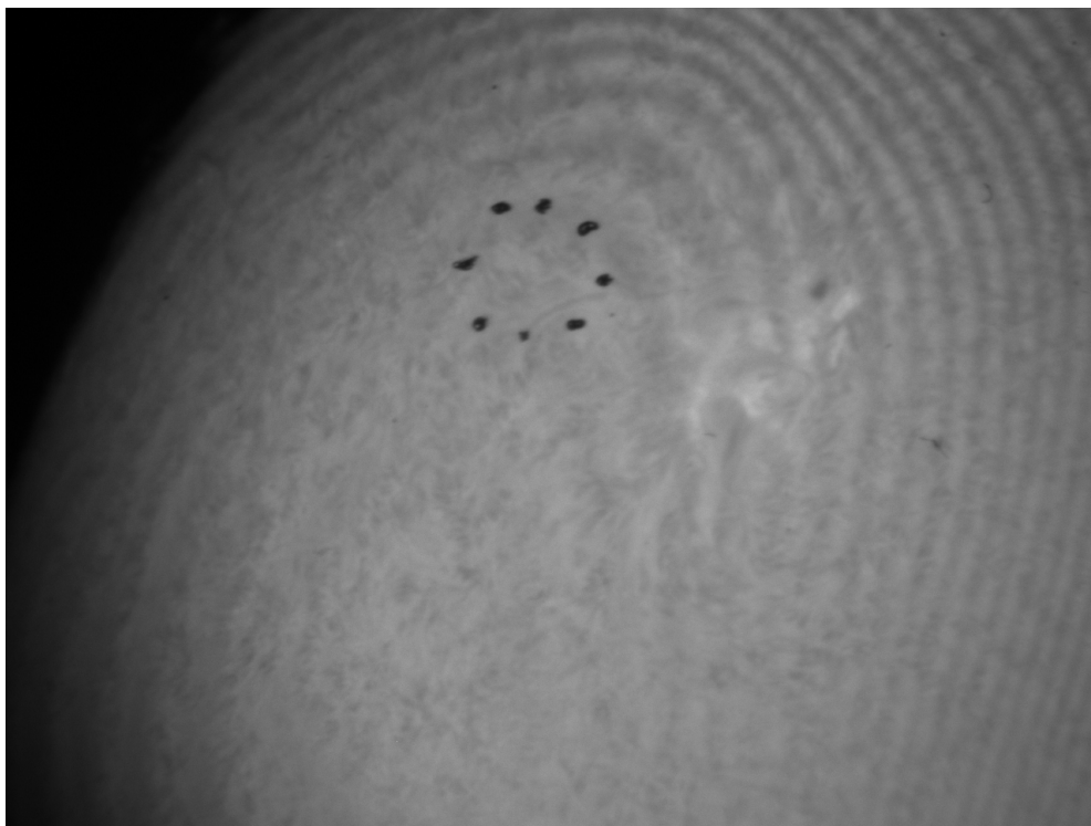
Obrázek 3.7: Snímek ze SJ zobrazovacího systému v úvodní fázi testování, na kterém je vidět výrazný interferenční vzor. Tečkami je vyznačena přibližná poloha vstupního otvoru clony.
