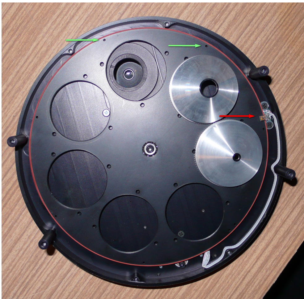
Obrázek 3.2: 1. verze karuselu (2013) se dvěma clonami. Červenou šipkou je vyznačena světelná závora, zelenými šipkami některé díry definující pozice clon.
