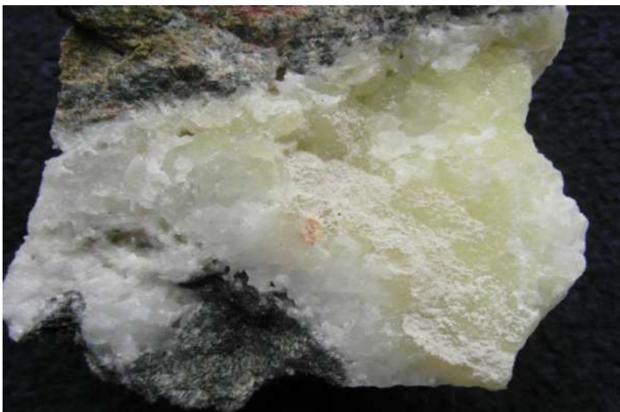
Obr. 88 Vzorek amfibolitu s ledvinitými agregáty prehnitu. Rok sběru 2014. Velikost prehnitové dutiny 6 x 5 cm. Foto a nálezce autor
