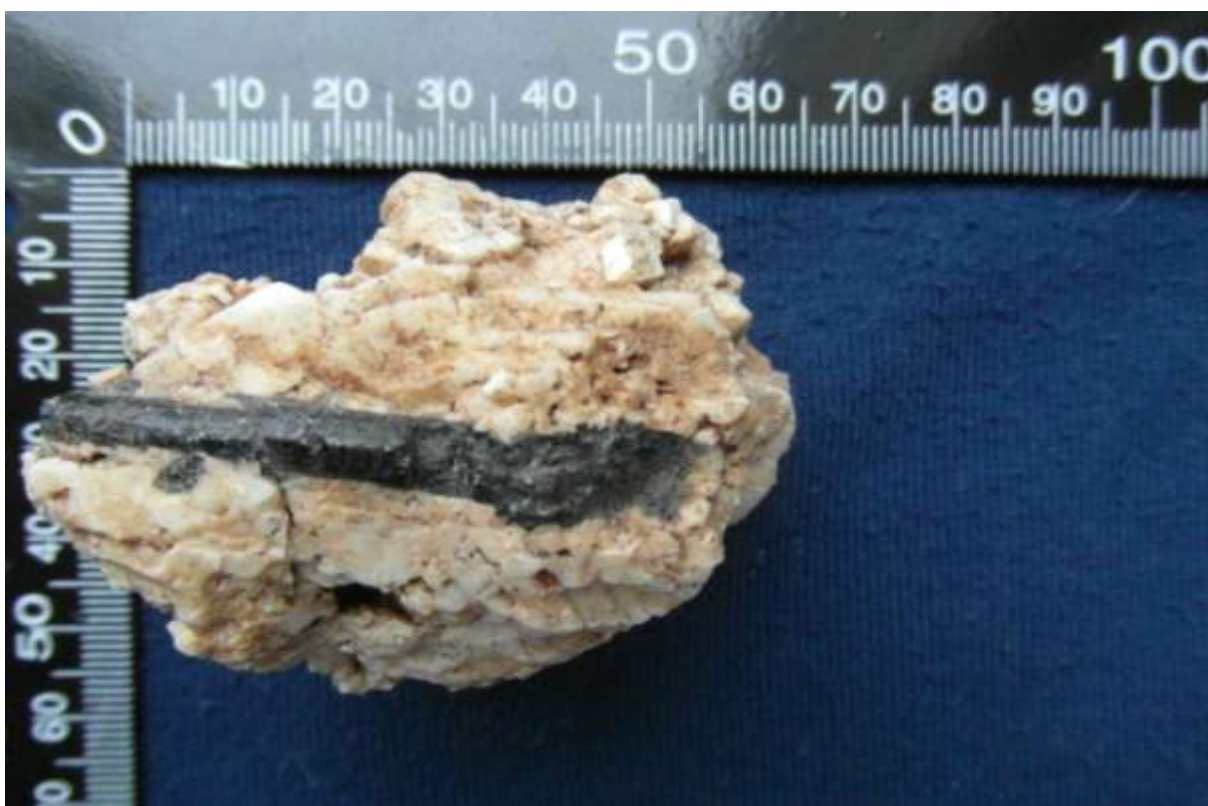
Obr. 191 Vzorek pegmatitu s krystalky albitu a sloupcovitého skorylu z lokality Věžná I.
