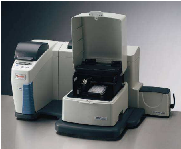
Obrázek 7 Disperzní Ramanův spektrometr – NICOLET DXR [9]
