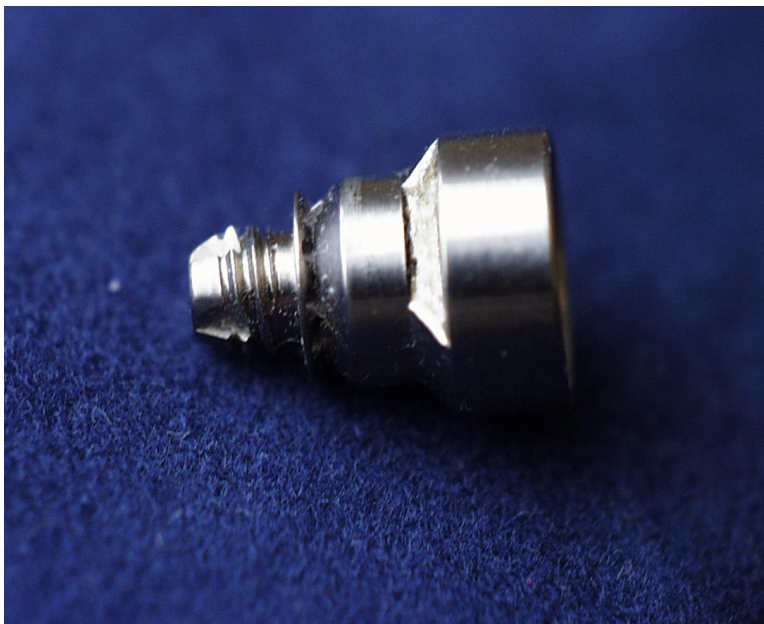
3 mm dlouhý titanový šroub s napojenou spojovací částí.
