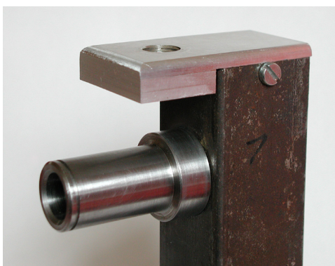
Obr. 29: - hřídel kloubu a držák aretačního mechanismu
