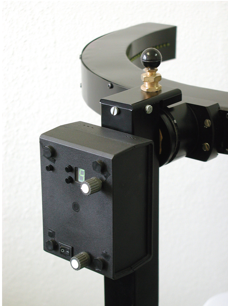
Příloha 9: přístroj zezadu – řídicí jednotka (nahore) a posuvné spojení ramene a stojanu (dole)
