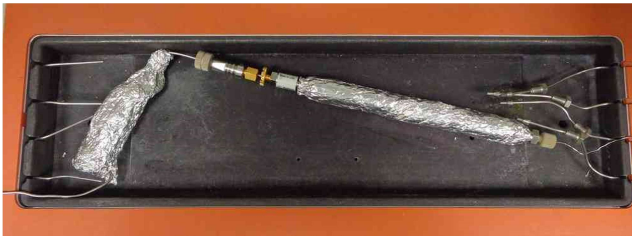
Obrázek 23. Uložení přehřevu mobilní fáze a kolony (obojí obalené hliníkovou fólií) v termostatu.
