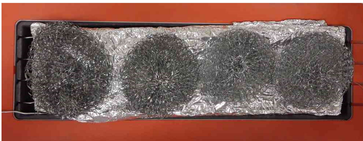
Obrázek 24. Překrytí kolony s přehřevem hliníkovou fólií a drátěnkami.
