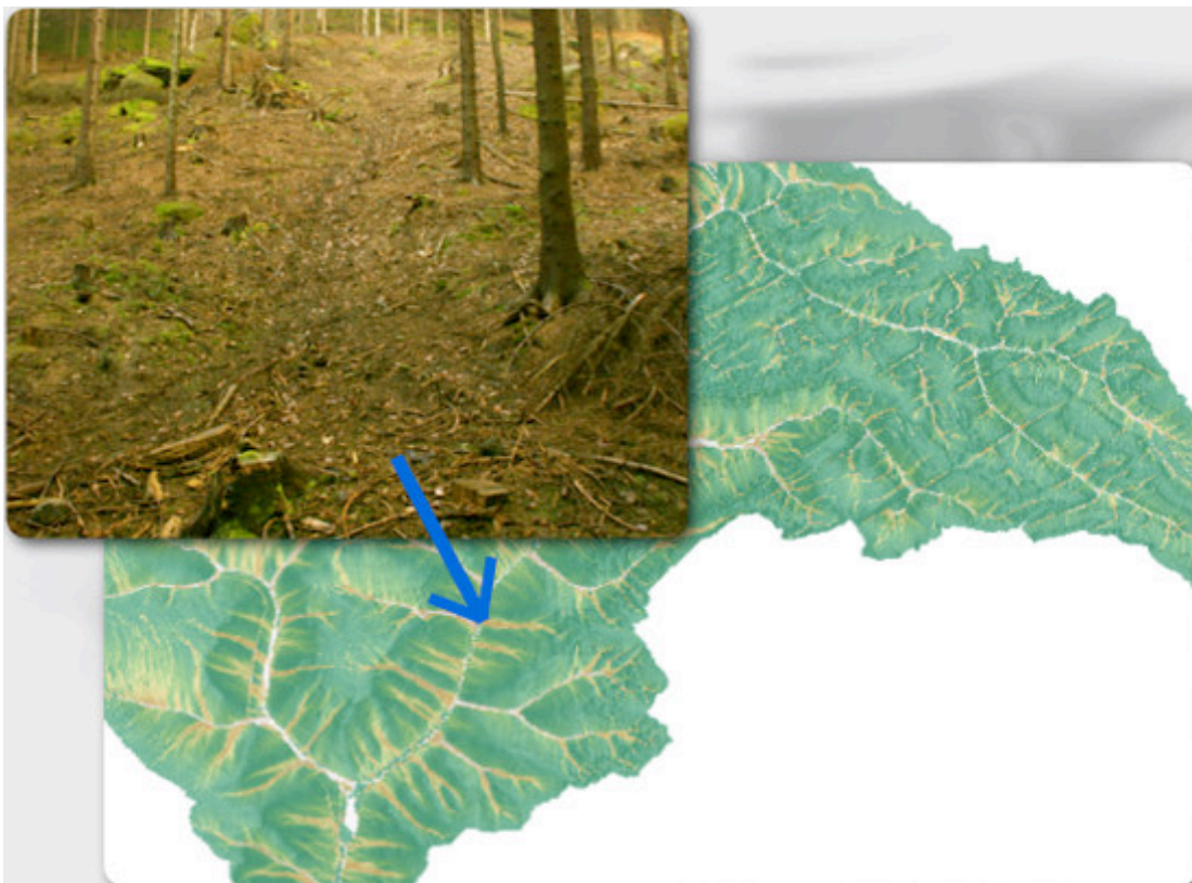
Obrázek 63 Ronová rýha a její poloha na mapě FA v povodí Suché Bělé.
