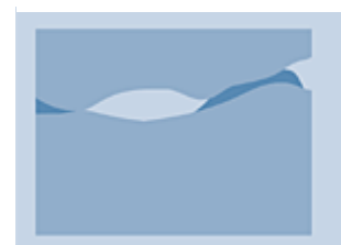
Obr. V.7: Schéma interakce povrchů při vzniku adhezního opotřebení (oerlikonbalzerscoating.com)
