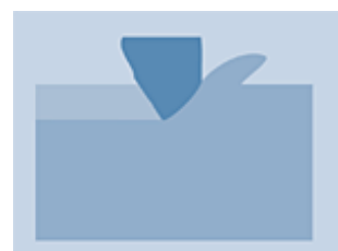
Obr. V.6: Schéma interakce povrchu opracovávaného materiálu a nástroje při abrazivním opotřebení (oerlikonbalzerscoating.com)
