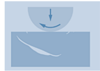
Obr. V.8: Schéma vzniku únavy povrchů (oerlikonbalzerscoating.com)
