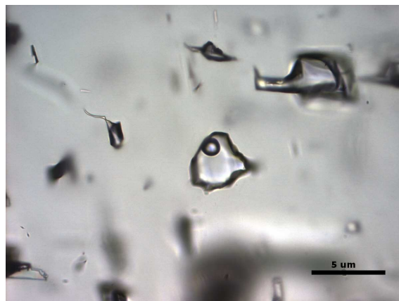
Obr. 25. Primární inkluze typu H 2 O-soli
