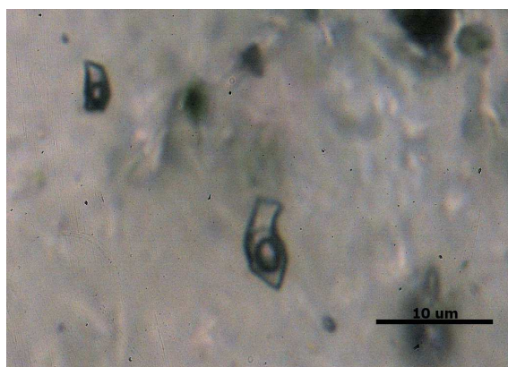
Obr. 28. Oddělení fází kapalného a plynného CO 2
