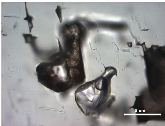
Obr. 22. Primární dvoufázová inkluze systému H 2 O-soli,
