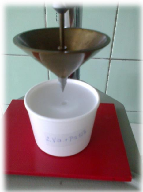
Obr. 27: Vazelína bílá s 10 % tvrdého parafinu připravená „litím“
