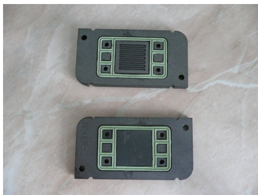
Obrázek 2.3: Zakládání cely: spodní deska s katodovým katalyzátorem
