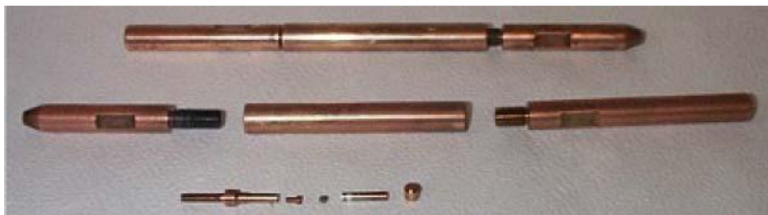
Obr. 3.7: Tlaková cela pro měření magnetizace a magnetické susceptibilitu v aparatuře MPMS.
