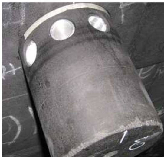
Obrázek 2.5: Detail grafitového válce s umístěnými vzorky [13].
