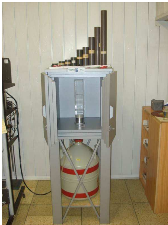
Obrázek 6.5: HPGe detektor použitý pro měření
