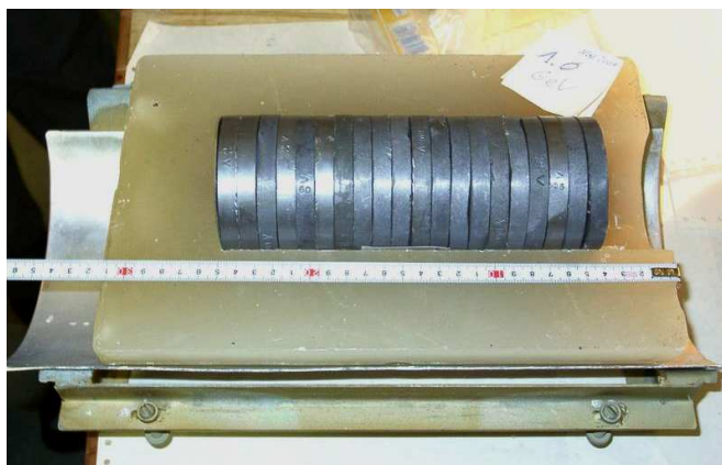
Obrázek 2.1: Otevřená sestava Gamma-2 s viditelným olověným terčem.
