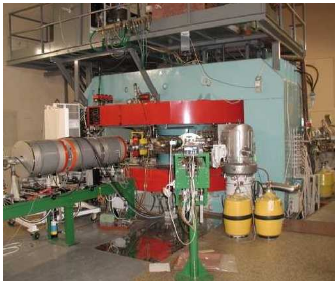
Obrázek 6.1: Isochronní cyklotron U120-M [13].
