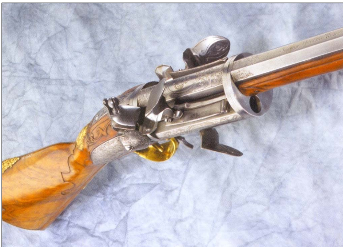
OBR. 32 Křesadlová puška revolverové konstrukce se třemi komorami, kterou sestrojil kolem roku 1730 karlovarský J. Haetischweiler (převzato z Vladimír DOLÍNEK: Čeští puškaři . Praha 2005, s. 121)
