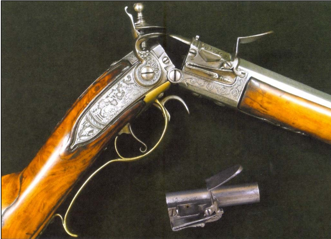
OBR. 33 Zadovka F. A. Šporka s vyměnitelnou železnou komorou, Johann Michael v Kuksu, kolem 1730 (převzato z Vladimír DOLÍNEK: Čeští puškaři . Praha 2005, s. 122).
