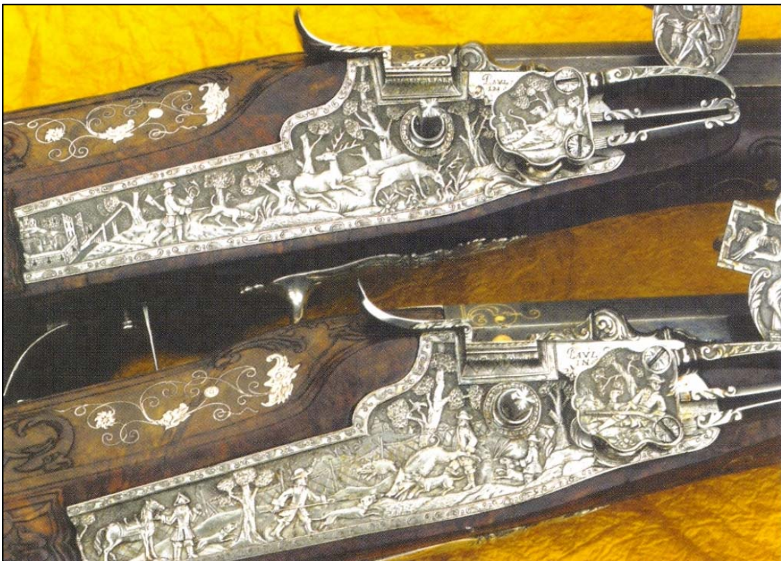
OBR. 34 Luxusní párové kulovnice, které pro schwarzenberskou knížecí zbrojnici vyrobil kolem roku 1740 vyhledávaný pražský puškař Paul I. Poser (převzato z Vladimír DOLÍNEK: Čeští puškaři . Praha 2005, s. 123).
