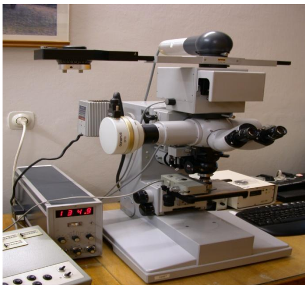
Obr. 16. Mikroskop UMSP 30 s bodovým integrátorem a digitálním ukazatelem naměřených hodnot odraznosti.
