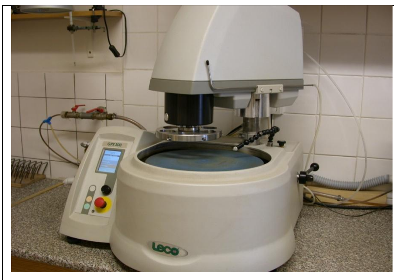
Obr. 15. Leco GPX 300 poloautomatická bruska a leštička pro přípravu zrnových nábrusů systémem postupného broušení a leštění nábrusů.
