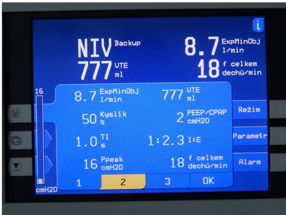
Obrázek č. 3 Nastavení parametrů ventilátoru při NIV, zdroj: archiv autora
