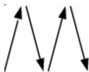
Obr. 2.11: Antiferomagnet, jehož spiny se vlivem Dzyaloshinskii-Moriyho interakce stočily, čímž se zabránilo jejich vykompenzování. Látka se tak chová jako slabý feromagnet [16].
