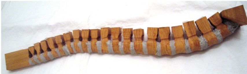
Obr. 2 Mechanický model páteře ze dřeva a silikonu.
