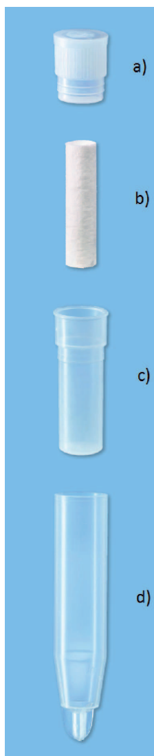
Obrázek 3.3: Jednotlivé části salivety: a) zátka, b) buničina, c) vložka, d) vzorková zkumavka [28].
