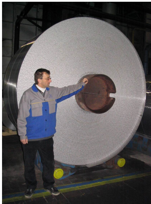
Obr. 2.9: Svitek hliníkové slity vyrobený metodou TRC, který bude následně žihán a válcován za studena
