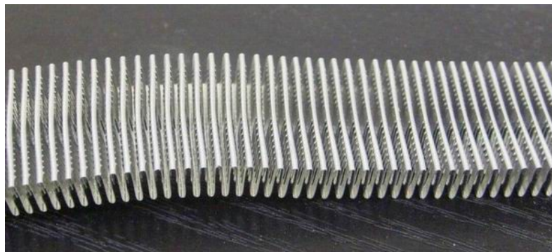
Obr. 2.10: Hliníková fólie vytvarovaná do vlnovce pro výrobu tepelného výměníku
