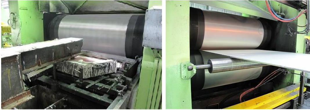
Obr. 2.8: Lití hliníkového pásu metodou TRC v praxi: roztavený hliník přiváděný tryskou k válcům a utuhlý pás tloušťky 8,5 mm
