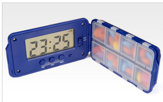
Obr. 17. Přístroj umožňující seniorům monitorování dávkování léků
