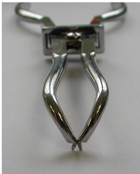
obr. 12 Nasazovací kleště zakončené hroty zapadajícími do otvorů ve sponě.
