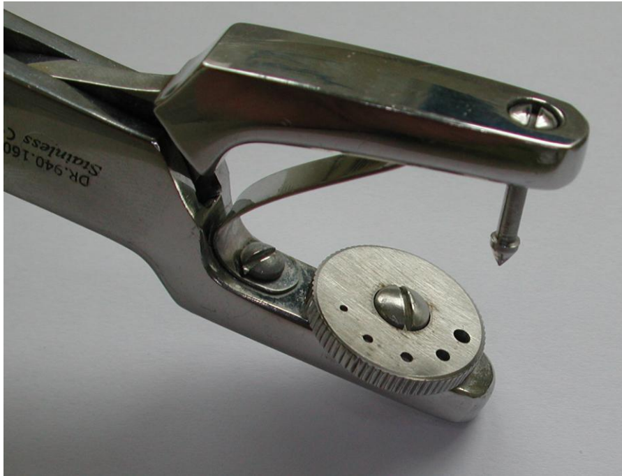
obr. 10 Detail perforačních kleští s kroužkem umožňujícím nastavení 5 různých velikostí otvorů.
