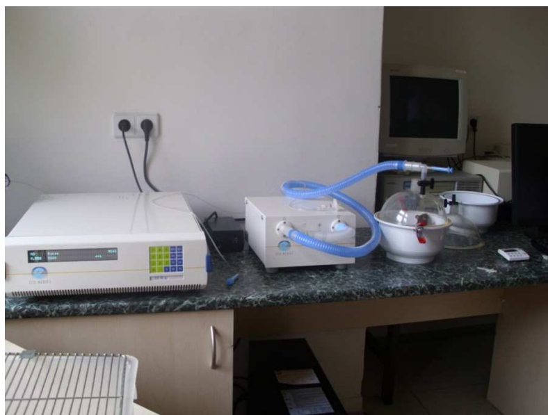
Obrázek 8: Měřicí komora na neinvazivní vyšetření vydechovaného NO a chemiluminiscenční analyzátor NO.
