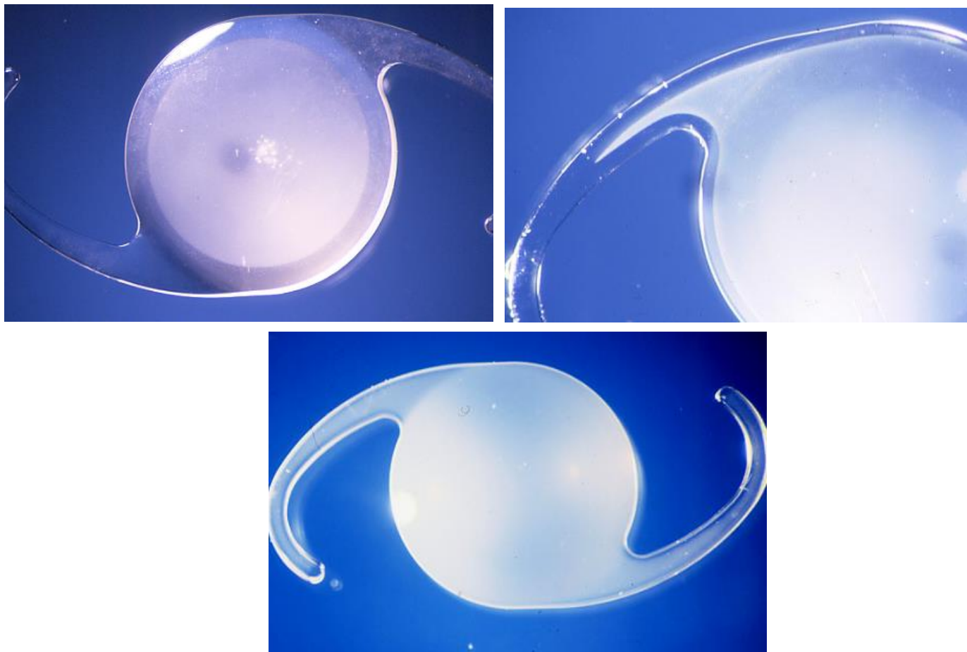
Gross makroskopický nález opacifikovanej SC60B-OUV™ VOŠ. Rôzne stupne opacifikácie optiky, ktorá prechádza do rôznej vzdialenosti haptikov.
