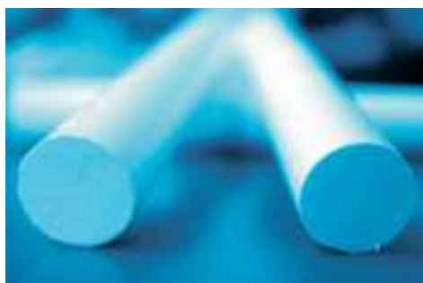
Obrázek 14 - Vysoce porézní monolitická tyčinka silikagelu [31]
