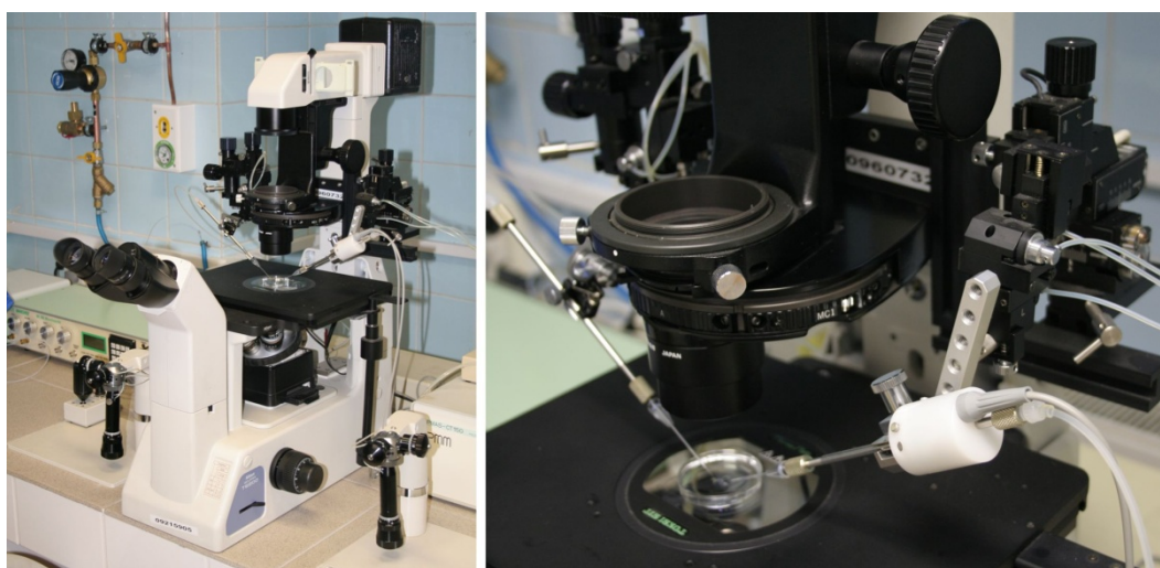
Obrázek 3: Mikroskop osazený mikromanipulátorem. V detailu dobře viditelný piezo aktuátor (bílý váleček) a držáky s kapilárami. Pohyb těchto kapilár je ovládán pomocí joysticků viditelných na celkovém pohledu.
