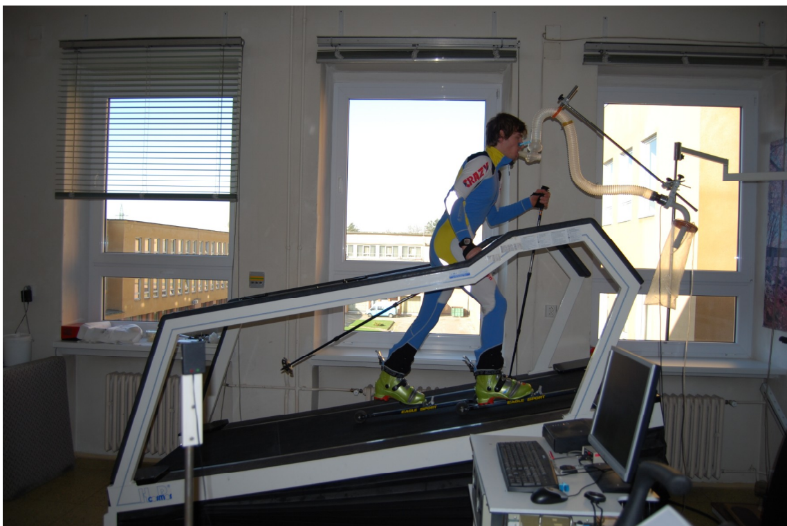
Příloha č. 4 Ilustrační foto probanda č. 2 při skialpinistické chůzi na upraveném běhacím ergometru s kolečkovými lyžemi se skialpinistickým vázáním a trekovými holemi
