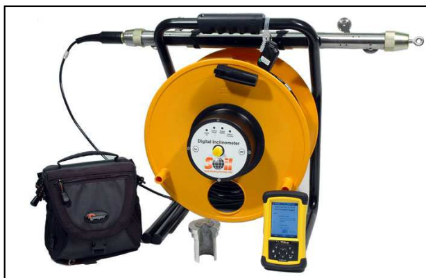
Obrázek 6 - měřicí sonda pro inklinometrii [6]
