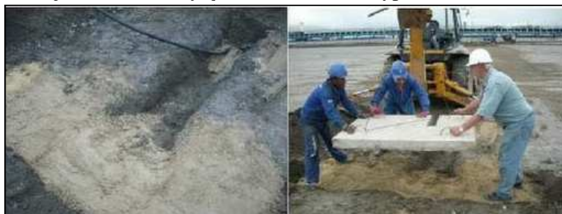
Obrázek 11 - měření sedání násypu deskou [6]
