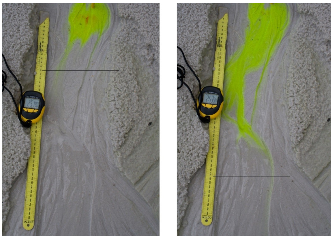
Obr. 15: Dokumentace měření rychlosti proudění nejmenších kanálků s vyznačeným čelem kontaminačního mraku fluoresceinu.
